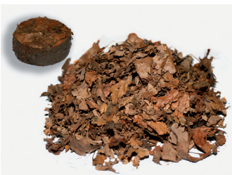
Abb. 149: Laubbrikett und äquivalenter Laubanteil (RIELA, www.riela.de ; NETZ Ingenieurbüro, www.netz-gmbh.eu )
